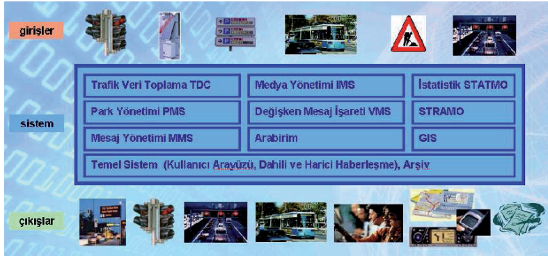
Şekil 2.2. Bir ITS içerisinde yer alan alt sistemlerden bazıları
