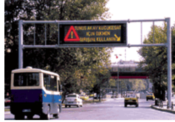
Resim 3.11. Trafik yönlendirme amaçlı kullanılan bir VMS [12]
